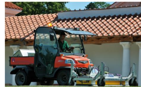
Das 2012 neu in Betrieb genommene motorisierte 16-Kanal MALÅ Imaging Radar Array zur effizienten hochauflösenden archäologischen Prospektion der Römerstadt Carnuntum.
