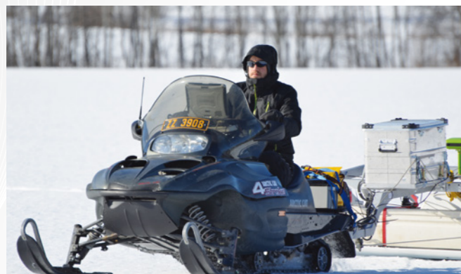
Multiantennen-Bodenradarsystem des LBI ArchPro für Messungen im Schnee, welches eigens für den Messeinsatz in Borre entwickelt wurde (Foto: LBI ArchPro, Erich Nau)
